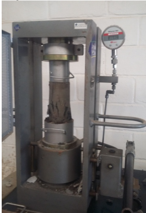
Figura 4 - ensaio de compressão em blocos de concreto.
