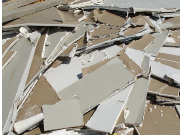
FIGURA4: Resíduos da Construção Civil Classe C
